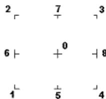
Il codice zero, che è inizialmente associato al centro pilastro, permette anche degli scostamenti imposti esplicitamente del filo fisso dal centro del pilastro
