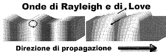
Figura 1: Rappresentazione grafica della propagazione delle onde superficiali di Rayleigh.
